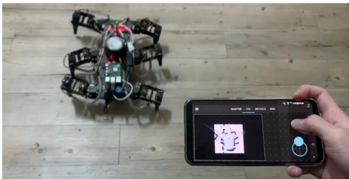
(圖二)可控制機器人移動並顯示地圖
