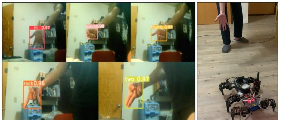
(圖七、八)類別與信心值(左圖)、手勢Hi使機器人做出抬腳動作(右圖)
